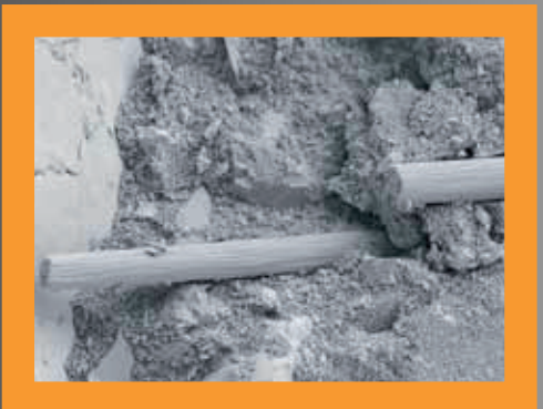
Photo microscopique qui montre l'incorporation nanocristalline d'une fibre de carbone dans CarboNit.
